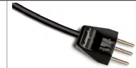
Schweizer Stecker Typ J, SEV1011 230 V AC; Kabellänge 1,0 m; Strom 10 A
