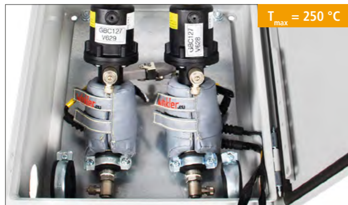
Serie WOT – Heizmanschetten für Messgasumschaltung
