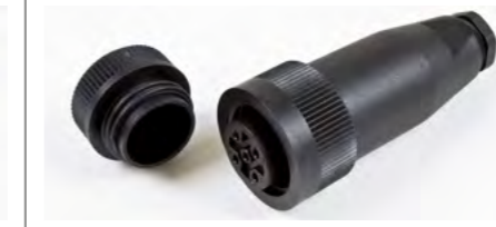
Mehrpolkupplung 4+PE (5pol) mit Abdeckkappe 400 V, 20 A, IP 65, Schraubanschluss, -40 °C / +100 °C
