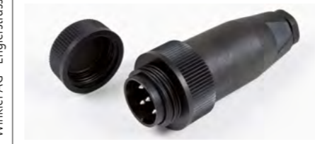
Mehrpolstecker 4+PE mit Sensoranschluss Mehrpolstecker 4+PE (5pol) mit Abdeckkappe 400 V, 20 A, IP 65, Schraubanschluss, -40 °C / +100 °C
