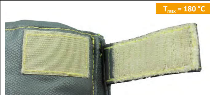
Hochtemperaturklett Haken aus rostfreiem Edelstahl, Flausch aus 100% Aramid, beständig gegen sehr hohe Temperaturen, selbstverlöschend. Serien WOT, WOG, WOQ
