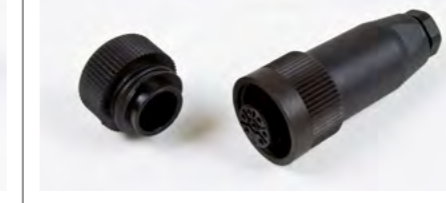
Mehrpolkupplung 6+PE (7pol) mit Abdeckkappe 250 V, 10 A, IP 65, Schraubanschluss, -40 °C / +100 °C
