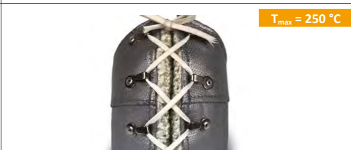
Hochtemperaturklett Haken aus rostfreiem Edelstahl, Flausch aus 100% Aramid, beständig gegen sehr hohe Temperaturen, selbstverlöschend. Serien WOT, WOG, WOQ
