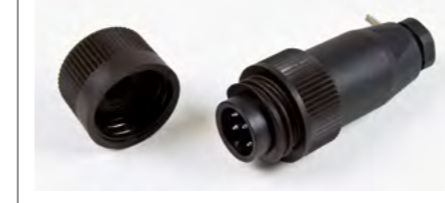
STANDARD Mehrpolstecker 6+PE mit Sensoranschluss Mehrpolstecker 6+PE (7pol) mit Abdeckkappe 250 V, 10 A, IP 65, Schraubanschluss, -40 °C / +100 °C
