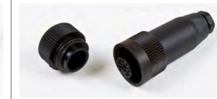
Mehrpolkupplung 3+PE (4pol) mit Abdeckkappe 400 V, 16 A, IP 65, Schraubanschluss, -40 °C / +100 °C
