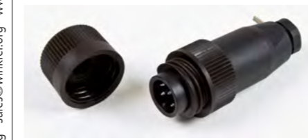
Mehrpolstecker 3+PE ohne Sensoranschluss Mehrpolstecker 3+PE (4pol) mit Abdeckkappe 400 V, 16 A, IP 65, Schraubanschluss, -40 °C / +100 °C
