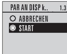
Im Messmodus drücken Sie ► um in den Programmiermodus zu gelangen. Wählen Sie Quick Start (1.), dann PAR AN DISP KOP (1.3). Drücken Sie ►, wählen dann START und drücken ►. PARAM UPLOAD wird angezeigt. Danach geht das Gerät in den Messmodus zurück.
