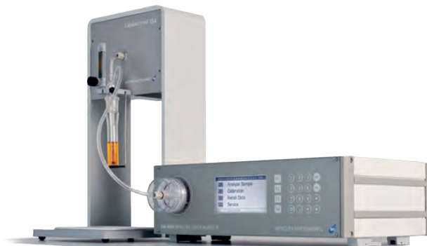
Erweiterung: Schnelle Quecksilberbestimmung im Labor mit dem Mercury LabAnalyzer 254.
