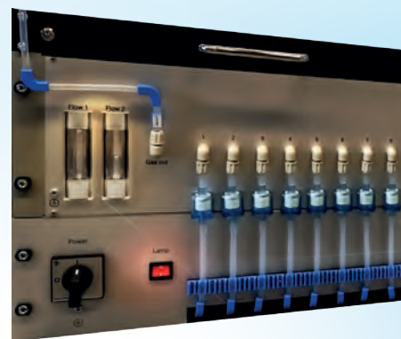
Option: Multiplexerbetrieb: Zur automatischen Messung an verschiedenen Messpunkten kann der VM-3000 mit einem Multiplexer betrieben werden.
