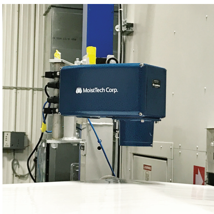
Für höchste Qualitätsansprüche: Die MoistTech NIR Online-Feuchtmessungssensoren ermöglichen eine vollständige Echtzeit-Prozesskontrolle in der Papierherstellung.
